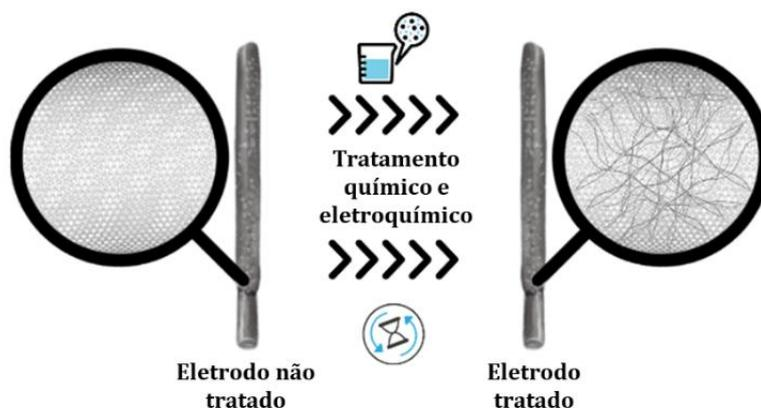
Figura 11. Eletrodo impresso em 3D antes e após os tratamentos de superfície. Os tratamentos removem parte do polímero isolante da superfície, expondo uma maior quantidade do material condutor.
