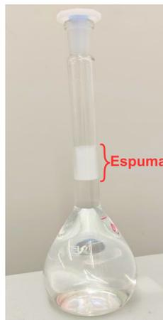
Figura 3.4: Solução recém-preparada em repouso para redução de espuma.
