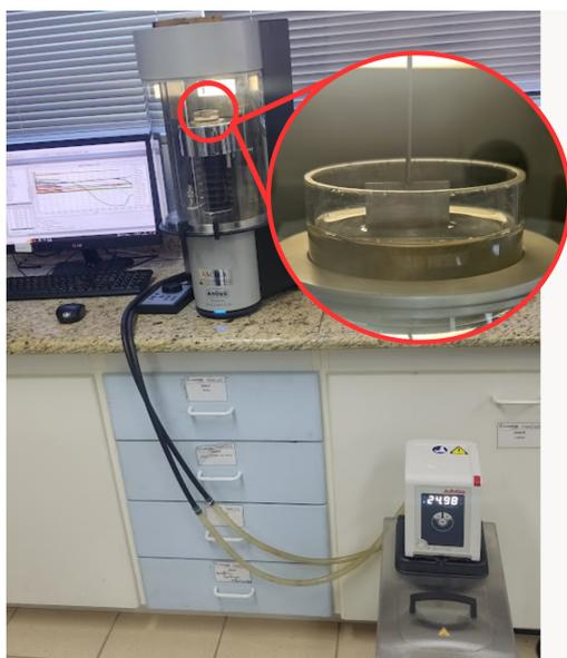
Figura 3.5: Tensiômetro de Placa de Wilhelmy da marca Krüss (modelo K100), utilizado para a medição de tensão superficial. O destaque em vermelho evidencia a placa em contato com a solução de água e surfactante contida na cubeta
