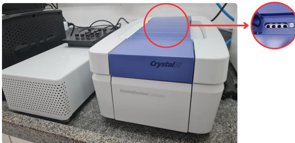
Figura 3.10: Equipamento *Crystal16*, da marca *Technobis Crystallization Systems B.V.*, utilizado para a medição de *Cloud Point*. O detalhe em vermelho destaca a tampa superior aberta de um dos quatro reatores, evidenciando os quatro compartimentos internos.
