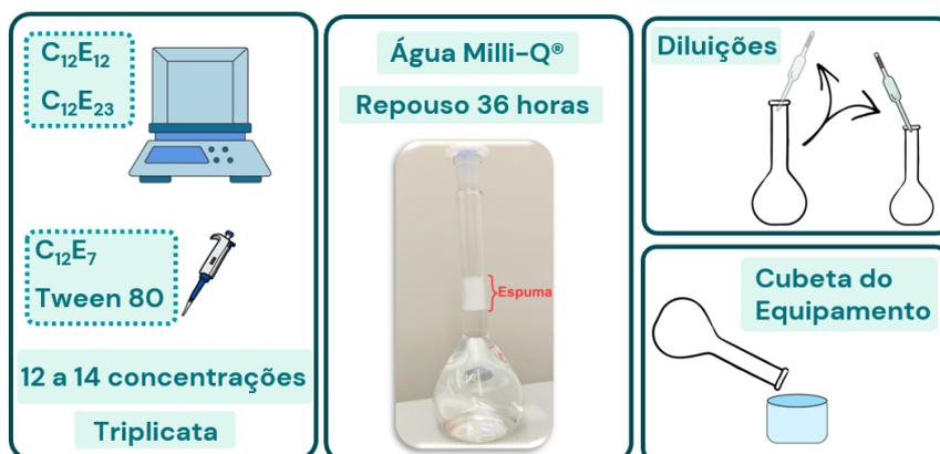
Figura 3.7: Esquema resumido do processo de preparação experimental das amostras para análise de CMC.
