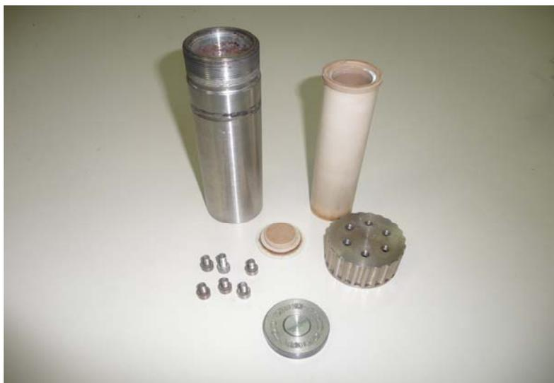
Figura 3.1: Célula e autoclave empregados na síntese da MCM-22.
