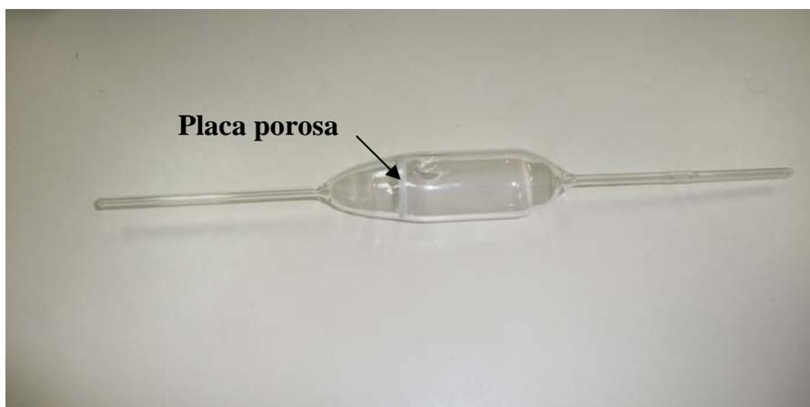
Figura 3.2 Reator para calcinação.
