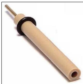
Figura 3.2. Eletrodo de pasta de carbono.
