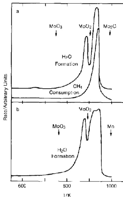
**Figura 6.** Perfil típico de TPR (a) Síntese do carbeto de molibdênio, (b) Redução do óxido de molibdênio.
