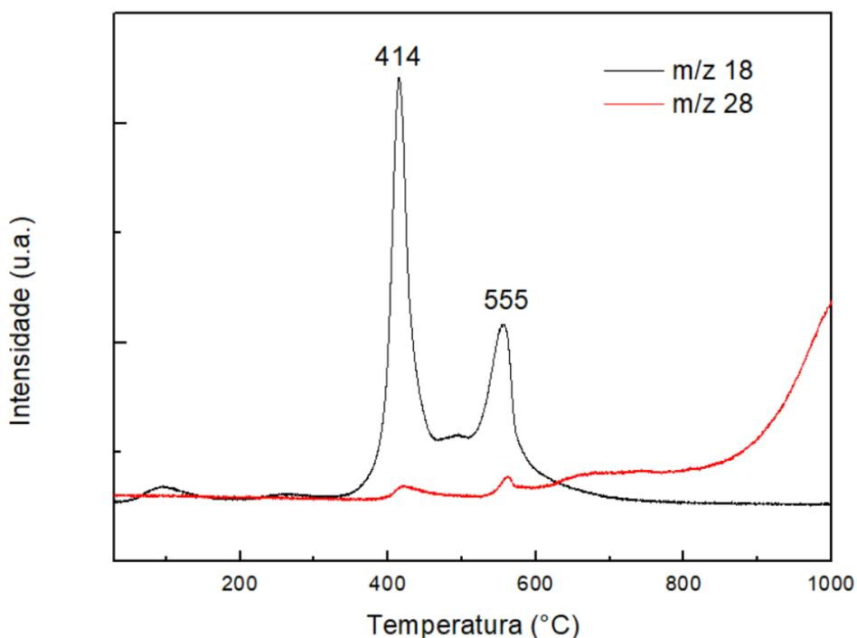
**Figura 15.** Perfis de formação de H<sub>2</sub>O e CO durante o TPC do precursor 28 % MoO<sub>3</sub>/USY.
