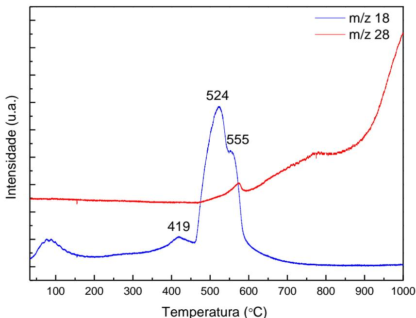
**Figura 17.** Perfis de formação de H<sub>2</sub>O e CO durante o TPC da amostra 24 % WO<sub>3</sub>/USY.
