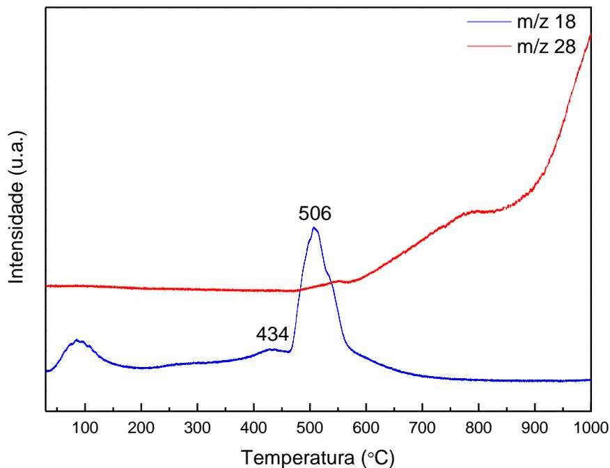
**Figura 18.** Perfis de formação de H<sub>2</sub>O e CO durante o TPC da amostra 12 % WO<sub>3</sub>/USY.
