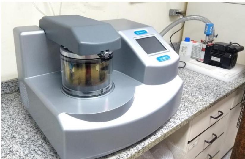
Figura 60. Metalizador modelo Q150R ES localizado no Laboratório de Membranas e Polímeros (PAM)
