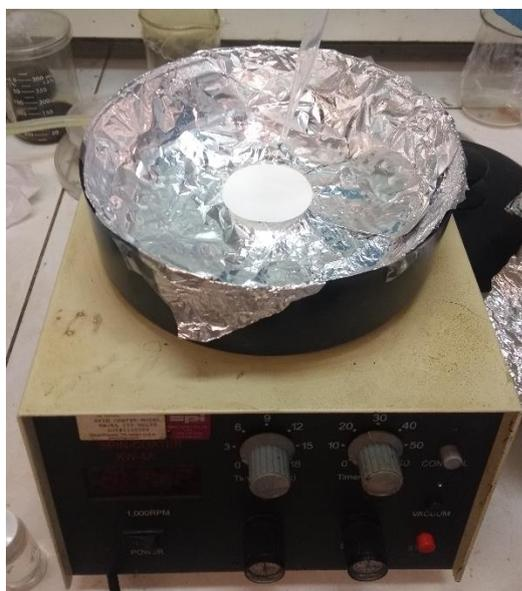
Figura 59. *Spin Coater* da Spi Supplies modelo KW-4A.
