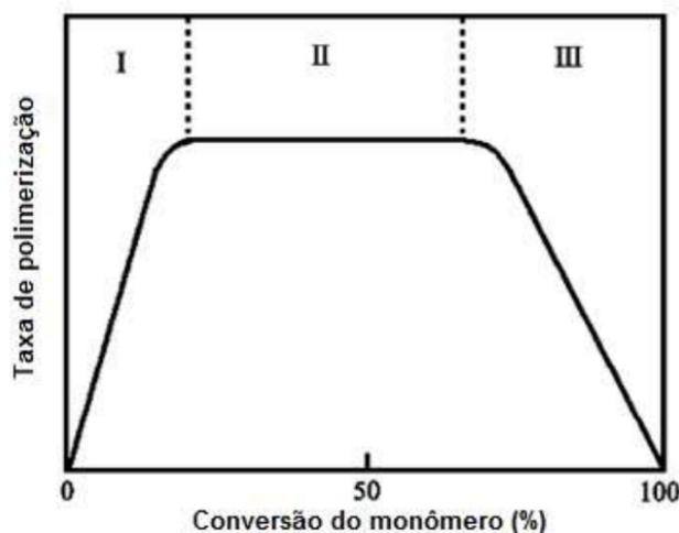
**Figura 7 - Representação esquemática da taxa de polimerização como função da conversão do monômero para polimerização em emulsão (CHERN *et al.*, 2006).**
